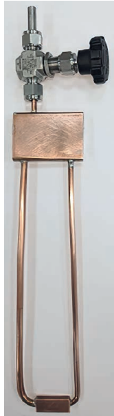
Рис. 3. Пульсирующий контурный термосифон с ультратонкой порошковой капиллярной структурой
