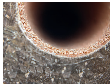
Рис. 4. Ультратонкая порошковая капиллярная структура в канале испарителя пульсирующего контурного термосифона ( D_{\text{вн}} = 3 мм)
