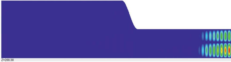
Рис. 5. Распределение модуля напряженности электромагнитного поля в продольном сечении волновода
