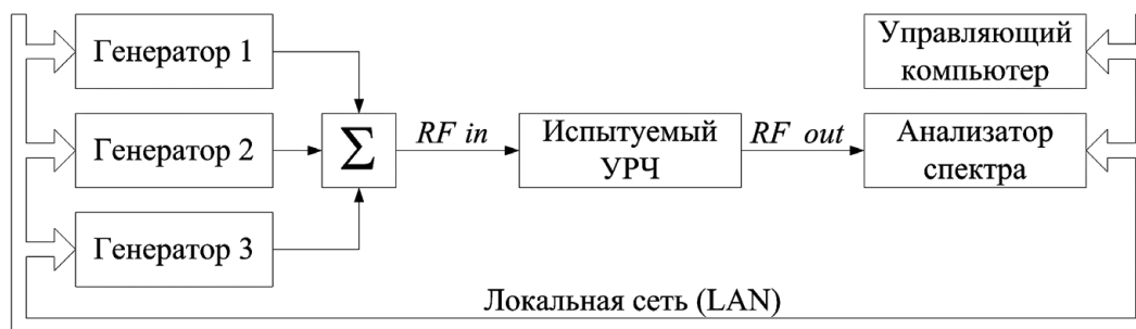
Рис. 1. Структурная схема автоматизированной системы двухчастотного зондирования при испытаниях усилителей радиочастоты: 1, 2, 3 – генераторы Agilent N5181A, E8257D, E4438C; анализатор спектра – Agilent N9020A
