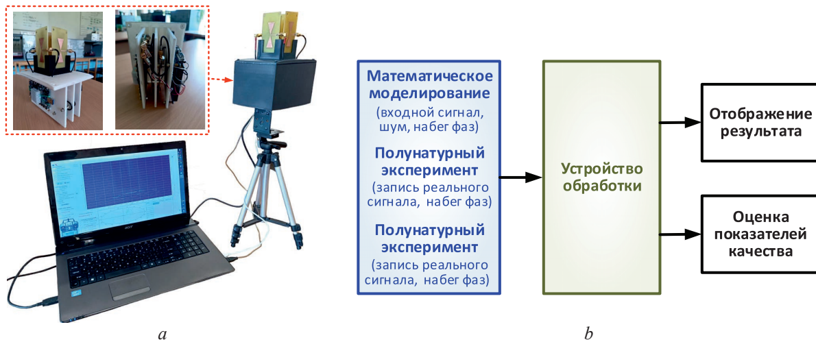
Рис. 8. Радиопеленгатор: а – внешний вид; б – схема проверки показателей качества Fig. 8. Radio direction finder: a – appearance; b – scheme of checking quality indicators
