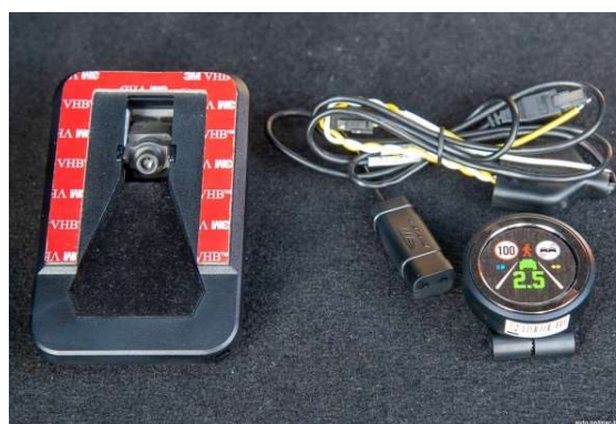
Рис. 3. Внешний вид комплекта системы ADAS Mobileye Fig. 3. Appearance of the ADAS Mobileye system kit
