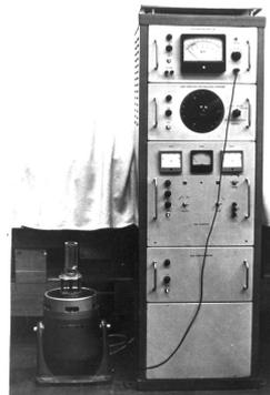
Рис. 1. Вибрационный стенд ВЭДС-10А
