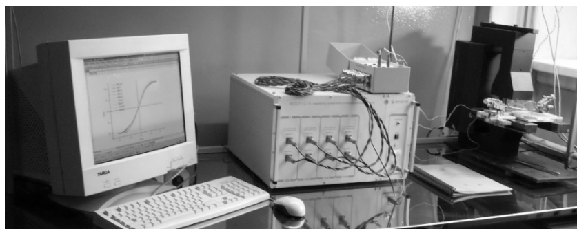
Рис. 2. Измерительный комплекс для определения коэффициента ГМС Fig. 2. Measuring system for determining the GMR coefficient
