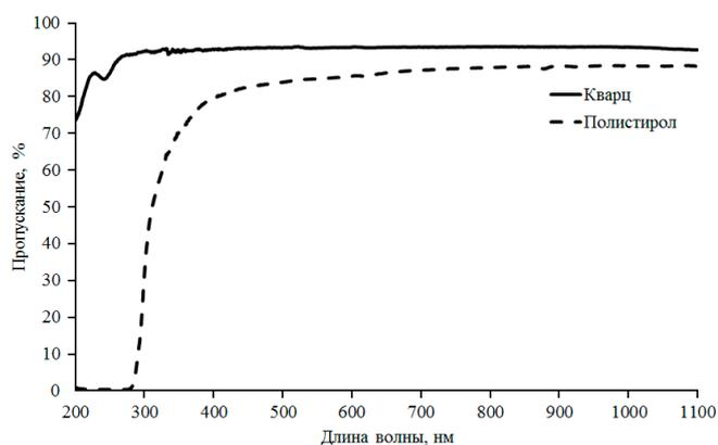
Рис. 3. Спектры пропускания окон, отделяющих светоизлучающий модуль от проточного реактора
