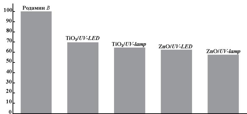
Рис. 4. Эффективность разложения красителя Родамин В в воде с использованием различных фотокатализаторов: TiO<sub>2</sub>/UV-LED – покрытие TiO<sub>2</sub> под облучением УФ светодиодом; TiO<sub>2</sub>/UV-lamp – покрытие TiO<sub>2</sub> под облучением УФ лампы; ZnO/UV-LED – покрытие ZnO под облучением УФ светодиодом; ZnO/UV-lamp – покрытие ZnO под облучением УФ лампы
