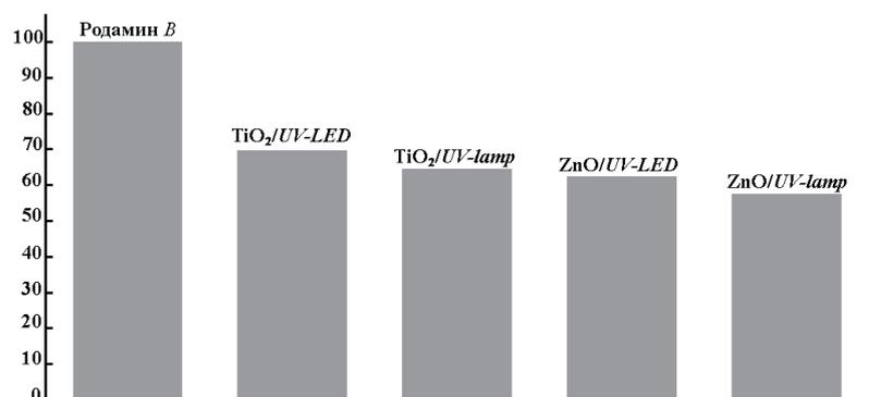
Рис. 4. Эффективность разложения красителя Родамин В в воде с использованием различных фотокатализаторов: TiO<sub>2</sub>/UV-LED – покрытие TiO<sub>2</sub> под облучением УФ светодиодам; TiO<sub>2</sub>/UV-lamp – покрытие TiO<sub>2</sub> под облучением УФ лампы; ZnO/UV-LED – покрытие ZnO под облучением УФ светодиодам; ZnO/UV-lamp – покрытие ZnO под облучением УФ лампы
