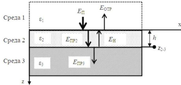
Рис. 1. Фрагмент слоистой среды и отражения электромагнитной волны
