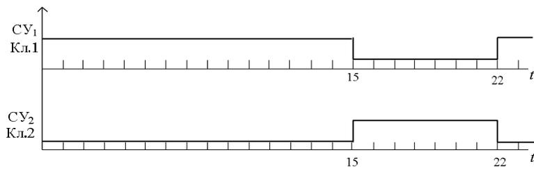
Рис. 3. Временные диаграммы сигналов управления ключами декодера
