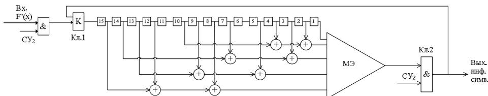
Рис. 2. Функциональная схема одноступенчатого мажоритарного декодера циклического  $(15; 7; d_0)$  – кода:  $\oplus$  – сумматор по модулю два,  $\boxed{к}$  – ключ управления декодера;  $\boxed{i}$  – ячейка памяти регистра сдвига,  $\boxed{к}$  – коммутатор; МЭ – мажоритарный элемент
