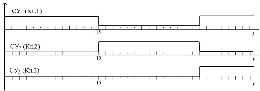
Рис. 5. Временные диаграммы сигналов управления ключами декодера
