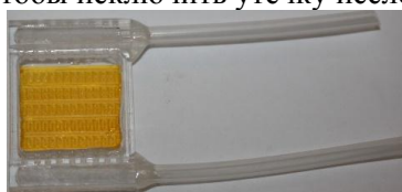
Рис. 3. Готовый для биомедицинского экспресс-анализа чип оптических резонаторов
