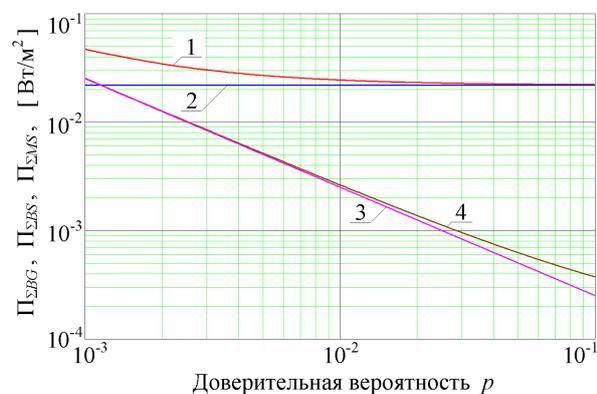
Рис. 1. Зависимости суммарной интенсивности ЭМФ и интенсивности его отдельных компонент от доверительной вероятности  $p$  при  $L_{TMS} = 10^{-4}$  Вт/м<sup>2</sup>,  $\Delta_{eBM} = 20$  дБ
