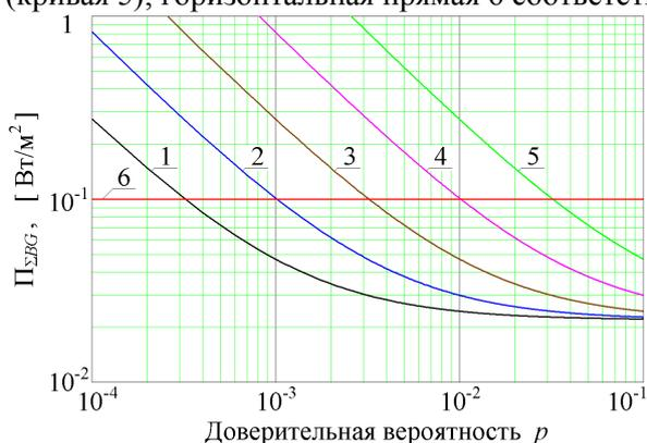
Рис. 5. Зависимости суммарной интенсивности ЭМФ от доверительной вероятности  $p$  при  $\Delta_{eBM} = 20$  дБ и  $L_{TMS} = 10^{-4}$  Вт/м<sup>2</sup>, для различных уровней  $D_L$  локального превышения в окрестности точки наблюдения средней ЭМН на территорию, создаваемой АС
