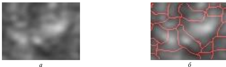
Рис. 3. Результат полутонового утоньшения: a – исходное изображение; б – алгоритм на основе ПДК с удалением хвостов
