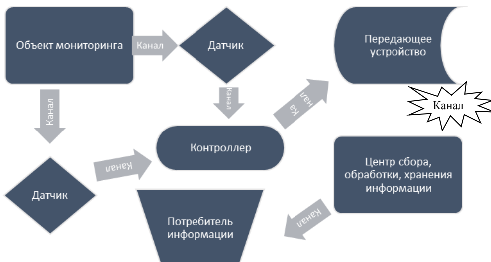
Рис. 2. Общая схема информационного взаимодействия основных элементов СДМПО, учитываемая при оценке эффективности внедрения
