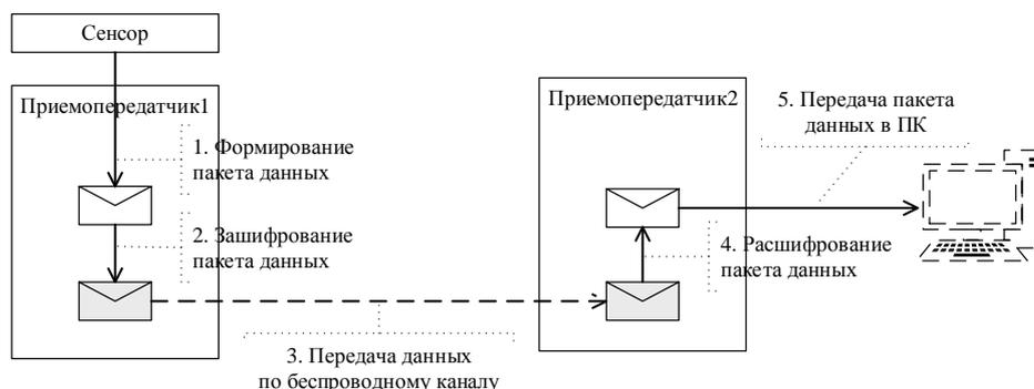
Рис. 1. Схема зашифрованной передачи информации в сенсорной сети
