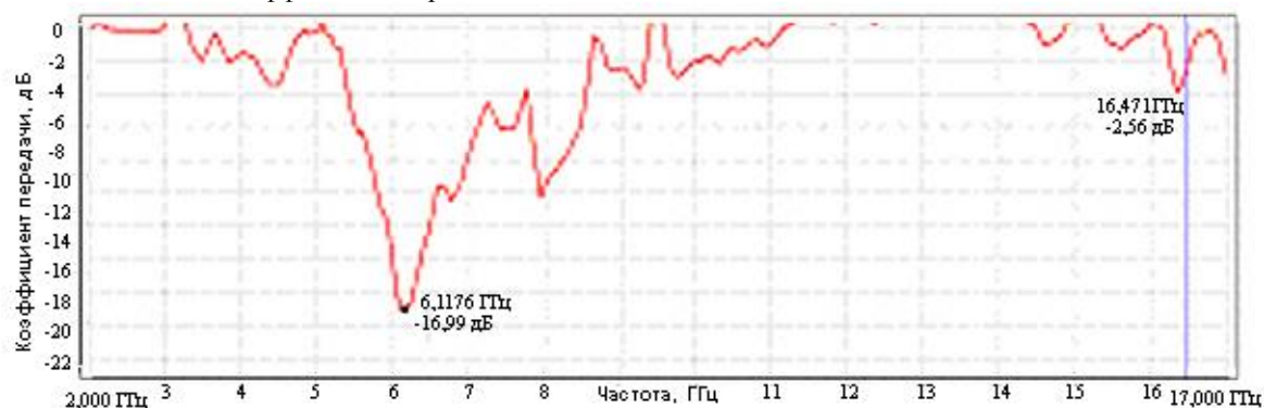
Рис. 8. Зависимость коэффициента отражения многослойного поглотителя в диапазоне от 2 до 17 ГГц
