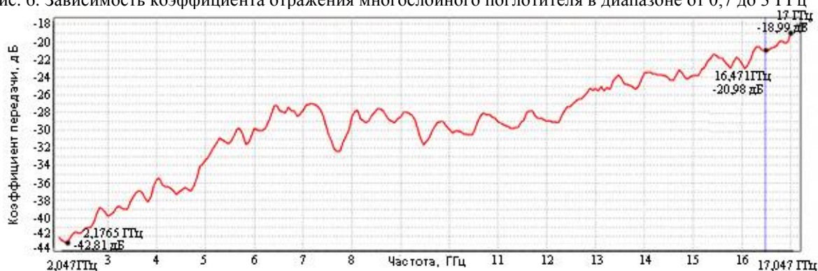
Рис. 7. Зависимость коэффициента передачи ЭМИ многослойного поглотителя в диапазоне от 2 до 17 ГГц
