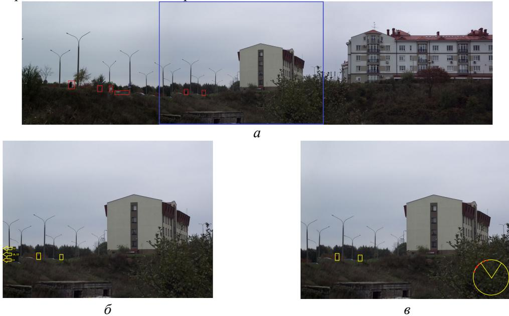
Рис. 2. Образец синтезированного изображения для НСИ: *a* – фрагмент исходного панорамного видеоизображения; *б* – стрелочная индикация подвижных объектов; *в* – азимутная индикация подвижных объектов
