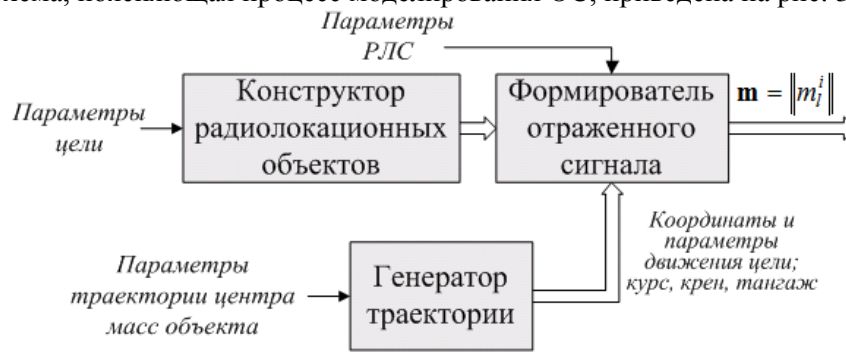
Рис. 2. Обобщенная структурная схема, поясняющая процесс моделирования ОС
