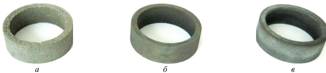
Рис. 4. Внешний вид спеченных пористых образцов до и после обработки: a – вид образца без обработки поверхности; б – вид образца с модифицированным слоем \text{Ti}(\text{HPO}_4)_2 \cdot \text{H}_2\text{O} ; в – вид поверхности образца со слоем \text{TiO}_2 после химического оксидирования
