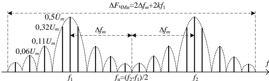
Рис. 2. Спектр двоичного ЧМн-сигнала.
