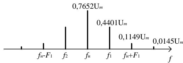
Рис. 4. Спектр ЧМн-колебания при индексе ЧМн  $m_{\text{ЧМ}}=0,8$  [7]
