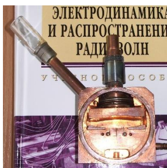
Рис. 5. Фотография разобранного лабораторного макета 0,1 ТГц орбитрона–генератора
