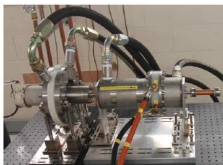
Рис. 2. Гиро-ЛБВ на испытательном стенде (IVEC – 2012. Р. 218)
