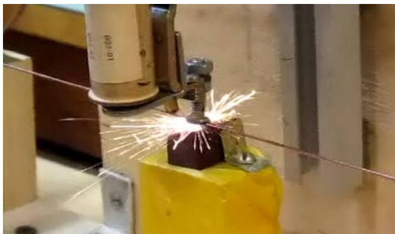
Рис. 1. Принципиальная схема установки для электроконтактной обработки образцов (а) и фотография рабочей зоны (б)
