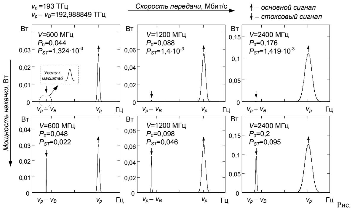
Рис. 4. Спектральные плотности сигналов накачки и стоковых компонент при различных скоростях передачи
