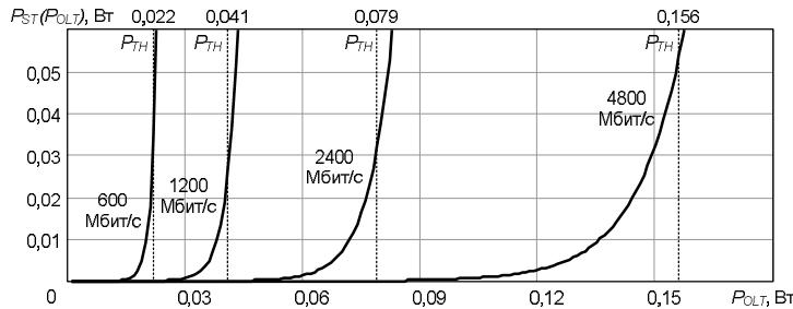
Рис. 3. Зависимости полной стоковой мощности от накачки
