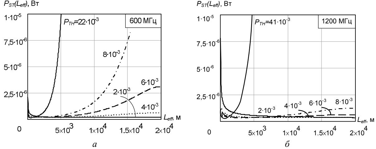
Рис. 5. Графики зависимостей полной стоксовой мощности от эффективной длины волокна при скоростях передачи 600 Мбит/с (а) и 1200 Мбит/с (б)
