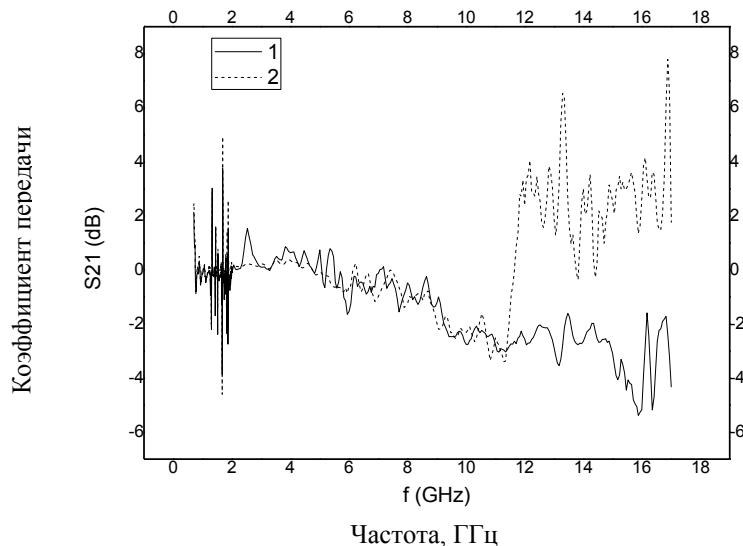
Рис. 3. Частотные зависимости коэффициентов передачи пористых порошков электрокорунда, не содержащих (1) и содержащих воду (2)
