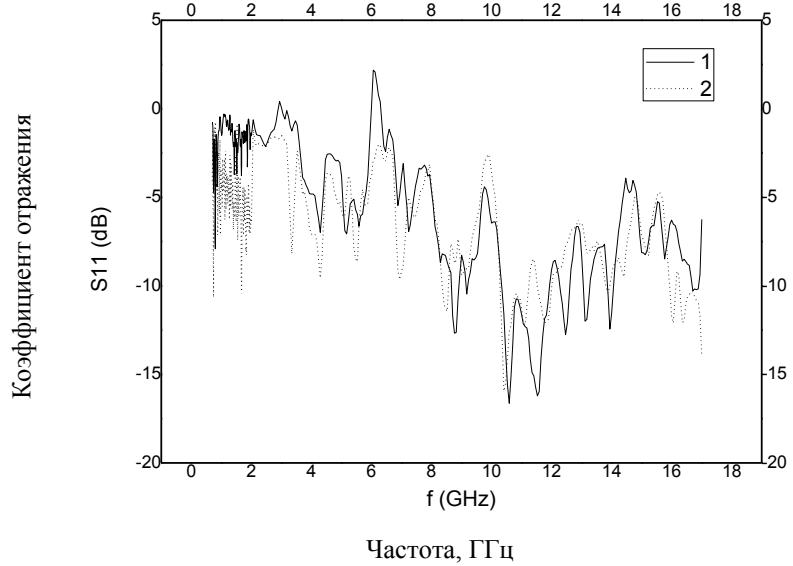
Рис. 4. Частотные зависимости коэффициентов отражения порошков электрокорунда, не содержащих (1) и содержащих воду (2)
