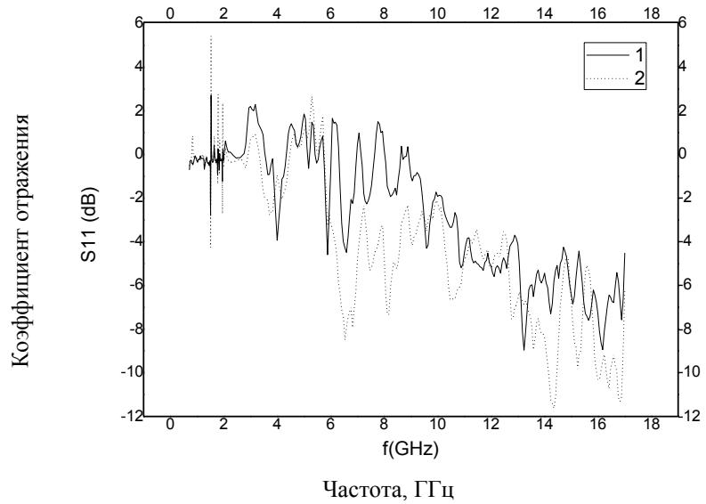
Рис. 5. Частотные зависимости коэффициентов отражения порошкового электрокорунда не содержащих (1) и содержащих воду (2)
