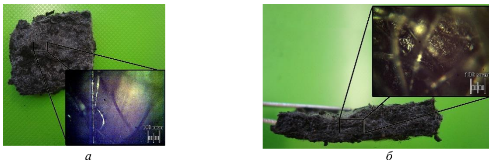
Рис. 3. Цифровая фотография поверхности (а) и поперечного среза (б) синтетического нетканого материала, пропитанного эмульсией поливинилацетата с добавлением технического углерода
