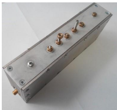
Рис. 6. Общий вид ( a ) и внутреннее конструктивное исполнение ( б ) полосового фильтра
