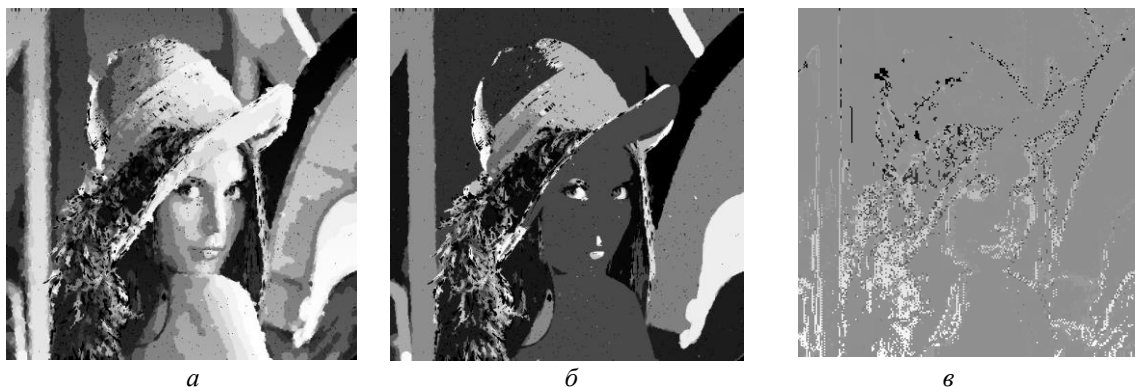
Рис. 1. Результаты сегментации стандартного тестового изображения Lena: а – результат для предложенного метода; б – результат для метода выращивания областей; в – результат для метода разделения и слияния областей
