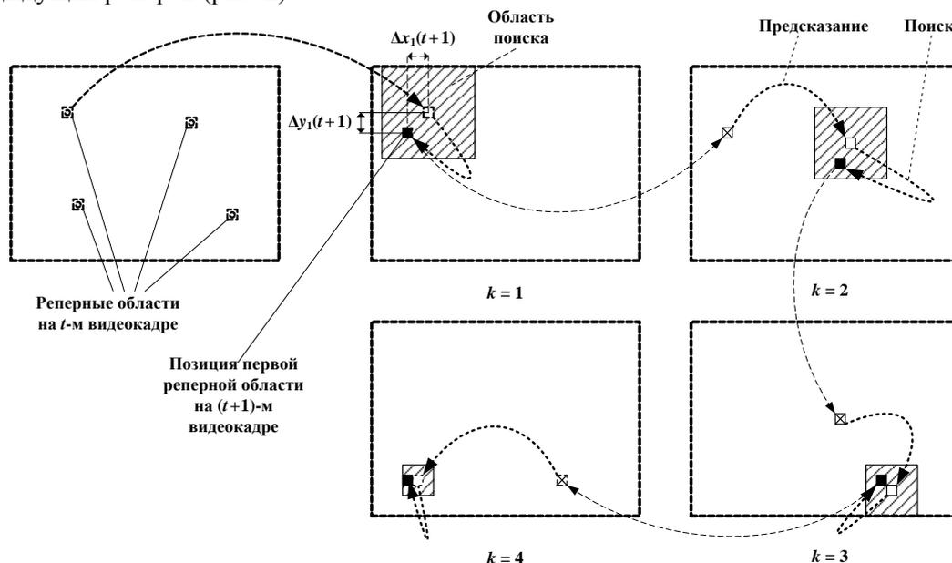
Рис. 2. Итерационное предсказание положения четырех реперных областей на  $(t+1)$ -м видеокadre для вычисления межкадровых смещений главной оптической оси видеокамеры
