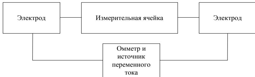
Рис. 1. Схема соединения элементов измерительной системы при измерении сопротивления влагосодержащего порошкообразного перлита
