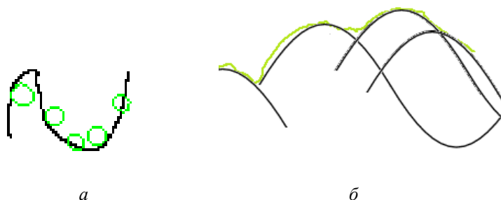
Рис. 3. Приближение кривых линий: а – кривыми второго порядка; б – синусоидами
