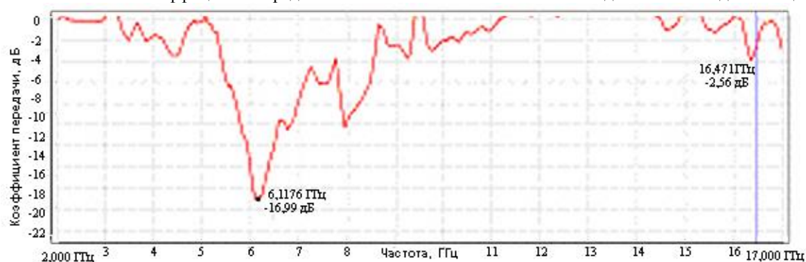
Рис. 8. Зависимость коэффициента отражения многослойного поглотителя в диапазоне от 2 до 17 ГГц
