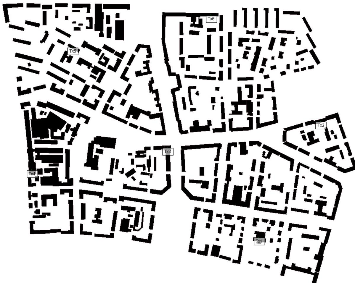
Рис. 1. Модель фрагмента городской застройки центральной части г. Минска с размещенными в нем шестью БС сети GSM-1800 (Тх1–Тх6).
