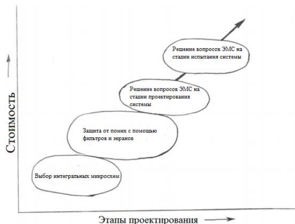
Рис. 2. Зависимость стоимости затрат по обеспечению ЭМС от этапа проектирования.
