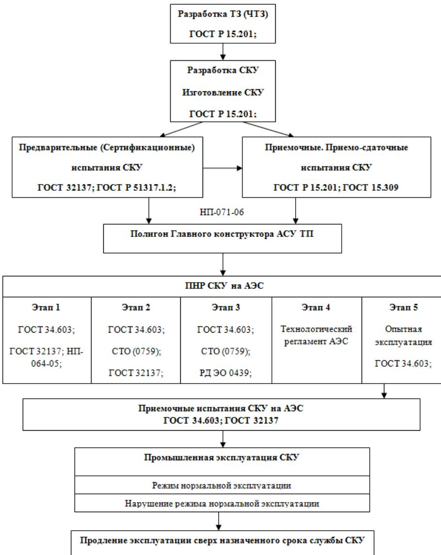
Порядок подтверждения соответствия СКУ требованиям обеспечения электромагнитной совместимости и функциональной безопасности на этапах жизненного цикла
