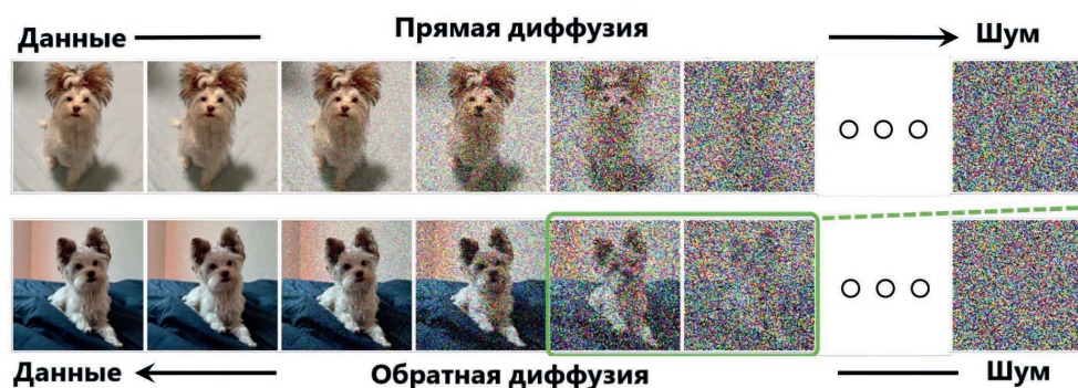
Рис. 1. Процесс прямой и обратной диффузии Fig. 1. Forward and reverse diffusion process
