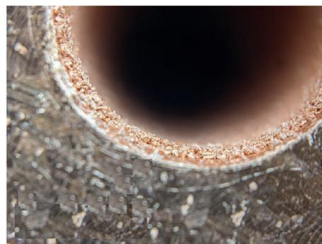
Рис. 4. Ультратонкая порошковая капиллярная структура в канале испарителя пульсирующего контурного термосифона ( $D_{\text{вн}} = 3$  мм)
