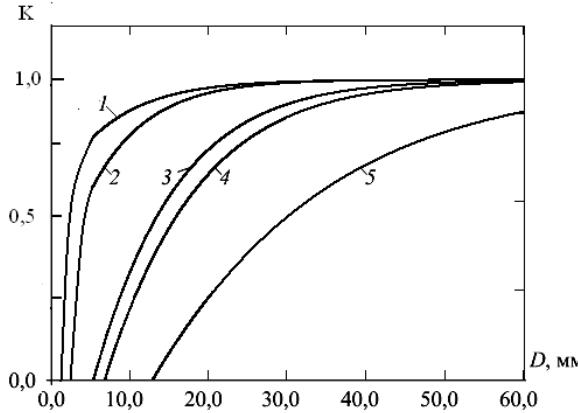
Рис. 2 Зависимость коэффициента  $K$  от диаметра макроизгиба: 1 – длина волны оптического излучения  $\lambda_1 = 850$  нм; 2 –  $\lambda_1 = 1310$  нм; 3 –  $\lambda_1 = 1490$  нм; 4 –  $\lambda_1 = 1550$  нм; 5 –  $\lambda_1 = 1625$  нм
