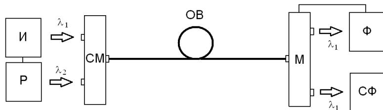
Рис. 1 Структурная схема экспериментальной установки: И – источники оптического излучения (лазер), СМ – оптический смеситель, ОВ – оптическое волокно, М – монохроматор, СФ – счетчик фотонов, Р – рефлектометр,  $\Phi$  – фотоприемное устройство
