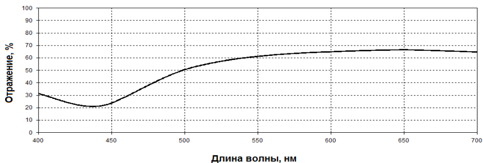
Рис. 5. Спектральная зависимость коэффициента отражения «золотого» покрытия
