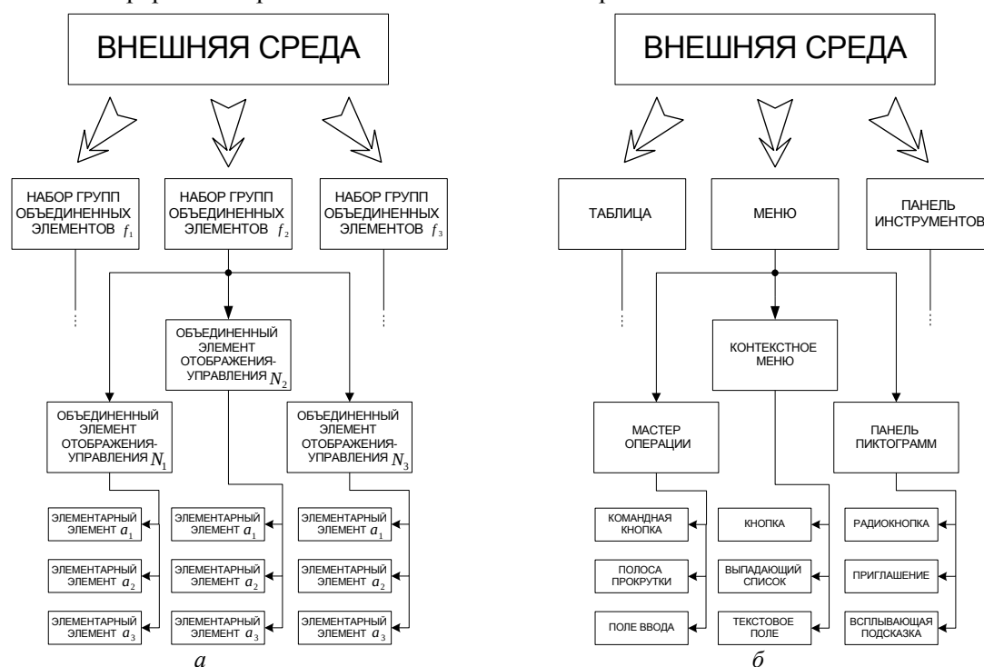
Рис. 2. Сравнение фрагмента предлагаемой информационной модели (а) и фрагмента информационной модели АСУ (б)
