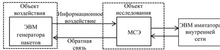
Рис. 3. Схема полунатурной модели ИТС
