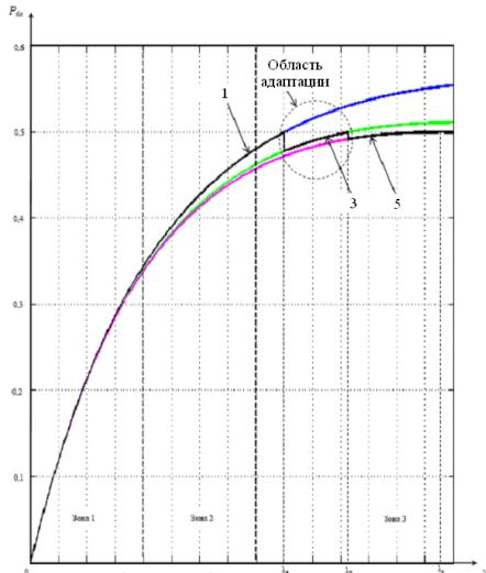
Рис. 7. Графики вероятностей блокировки сдвоенного МСЭ с адаптивным управлением
