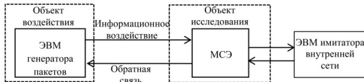
Рис. 3. Схема полунатурной модели ИТС
