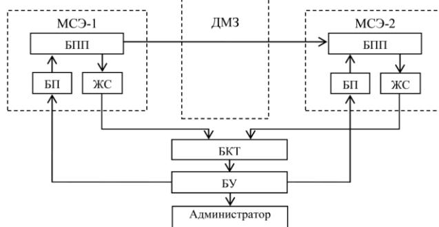
Рис. 2. МСЭ с адаптивным контуром управления, где БКТ – блок контроля трафика
