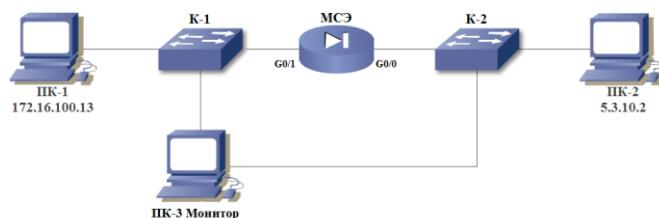
Рис. 4. Рабочая схема полунатурной модели ИТС
