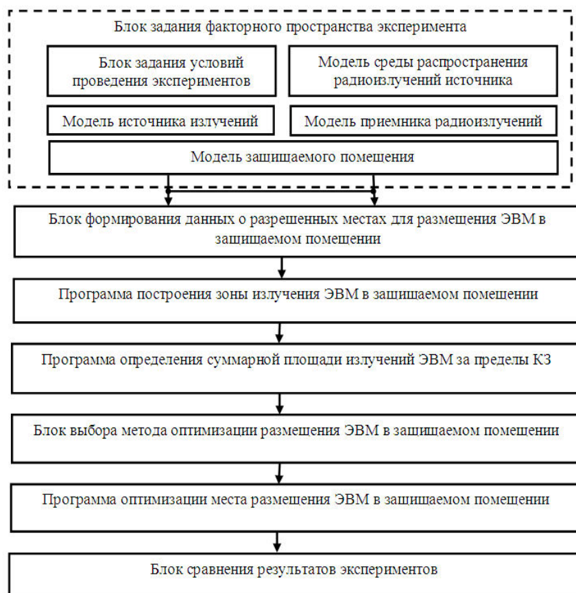
Рис. 1. Состав комплекса имитационного моделирования зоны излучения ЭВМ в защищаемом помещении
