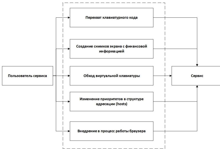
Рис. 5. Схема перехвата управления в сервисах безналичных электронных платежей
