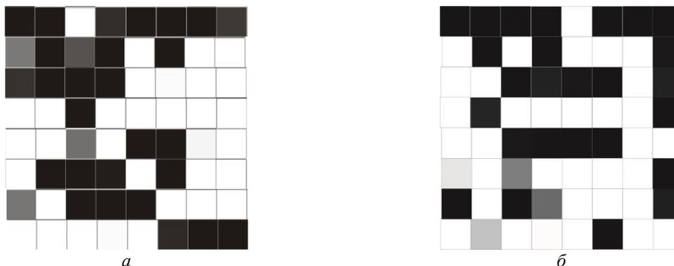
Рис. 3. Карты памяти «SRAM PUF»: *a* – для платы  $B_0$ ; *б* – для платы  $B_1$
