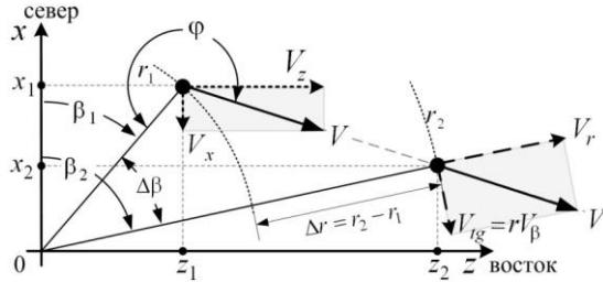
Рис. 1. Фильтруемые элементы в декартовой системе координат
