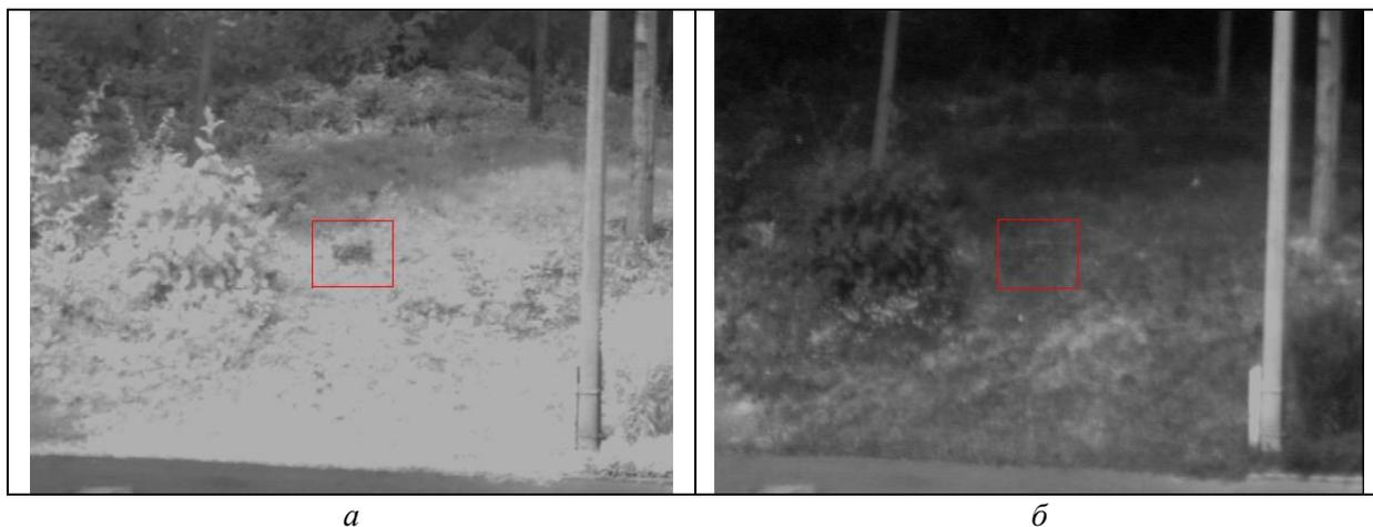
Рис. 7. Изображение маскировочного образца на фоне растительности при различных положениях поляризатора СВП
