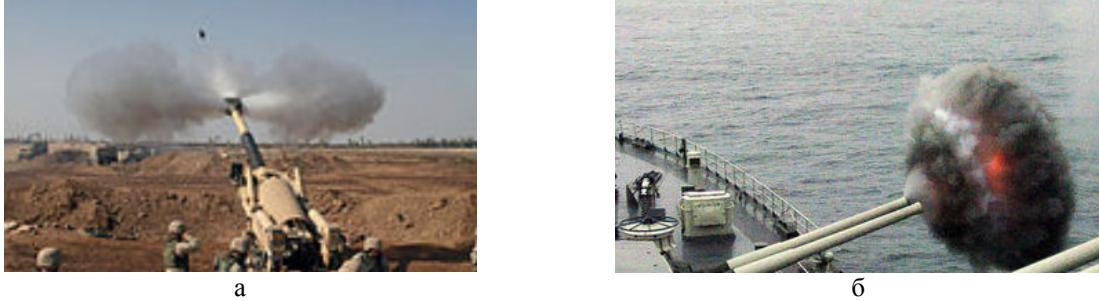
Рис. 1. Фотографии расширения ПГ на выходе из канала ствола артиллерийских систем:
