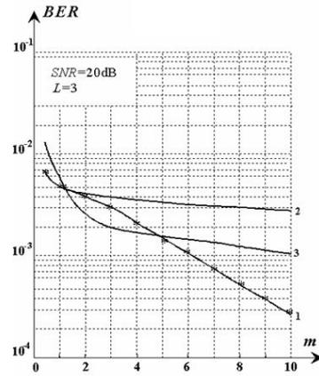
Рис. 2. Средняя вероятность ошибки как функция параметра замираний  $m$ . Накагами замирания при неоднородном (1) и однородном (2) распределении фазы; аппроксимация Накагами распределения (3); \* – результаты моделирования
