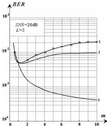
Рис. 1. Средняя вероятность ошибки как функция параметра замираний  $m$ . Накагами замирания при неоднородном (1) и однородном (2) распределении фазы; аппроксимация Накагами распределения (3); \* – результаты моделирования
