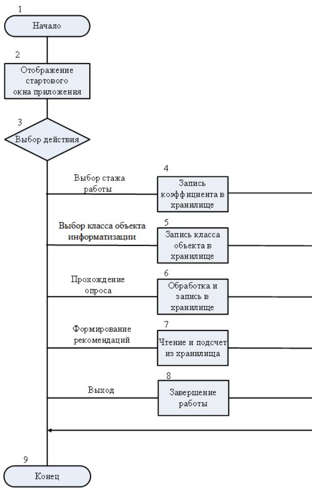
Рис. 1. Блок-схема алгоритма функционирования разработанного программного средства
